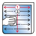
**8.** Folie mit der Klebeseite auf die Scheibe legen, anpassen und das Wasser mit dem Rakel ausrakeln.
